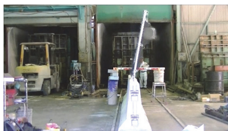
重錘衝突後の最大変形
